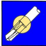
Vergewissern Sie sich vor einem Anbohrvorgang mit kleineren Durchmessern immer, dass die Bohrstange gegen unbeabsichtigtes Herausschießen gesichert ist
