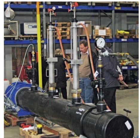
der ausgefrästen Platine wird wegen der verlängerten Fräserbaulänge ein längeres Ausstoßgerät benötigt.
