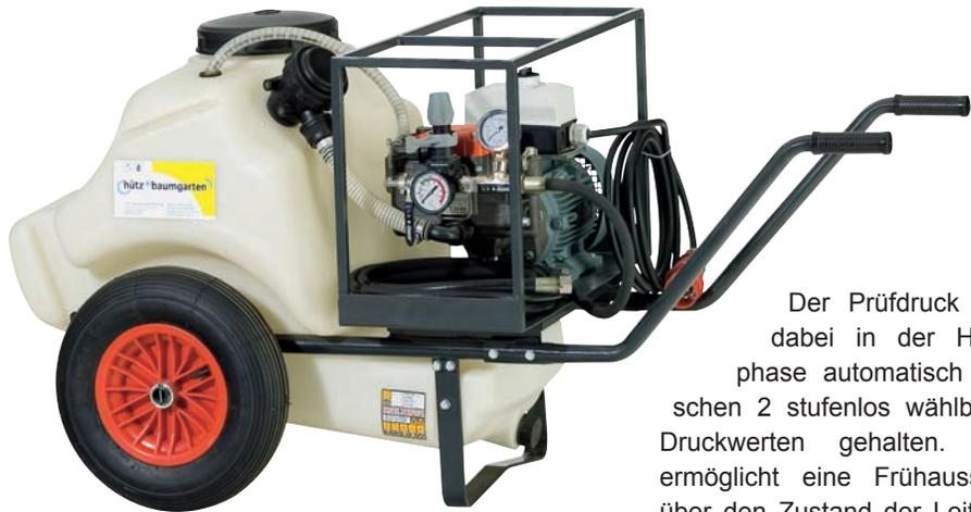
Der Prüfdruck wird dabei in der Haltephase automatisch zwischen 2 stufenlos wählbaren Druckwerten gehalten. Das ermöglicht eine Frühaussage über den Zustand der Leitung.
