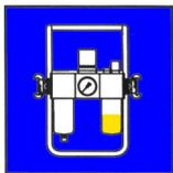
Achten Sie darauf, daß die Druckluftantriebe immer ausreichend und mit dem richtigen Öl versorgt werden!
