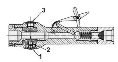
**Richtige Einstellung:** Unter Betriebsdruck (min. 6 bar) muß bei geöffneter Öleinfüllschraube (Pos.3) das Öl leicht brodeln.
