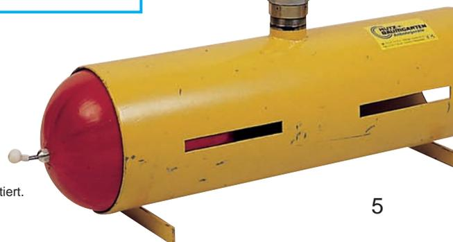
Einzelblasensetzgerät DN 80 - 400 auf einem DN 300 Stahlrohr montiert.
