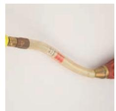
MDS-Blase: Füllschlauch verformt
